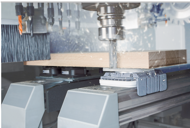
Blocksauger VCBL-K1 beim Aufspannen von Massivholz
